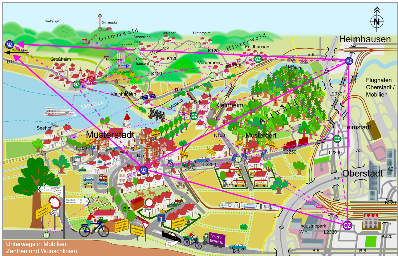
Abbildung 2.4 Wunschliniennetze als Luftlinienverbindungen. Zeichnung: Dirk Schmidt 09-2023).
