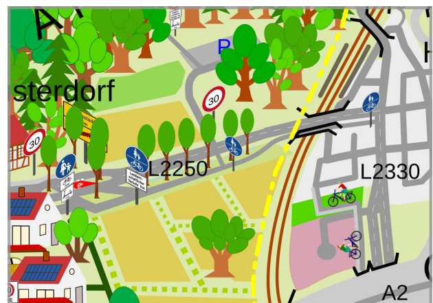
Abbildung 3.60 Blick auf die neue Radverkehrsanlage. Anmerkung: Die weißen Randlinien wurden hier nicht extra dargestellt. Die Radverkehrsanlage wurde komfortabel und sicher durch Entwässerungsgraben und Baumallee von der viel befahrenen L 2250 abgesetzt.
