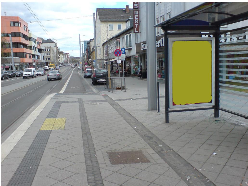
**Abbildung 11.17** Potentiell konfliktrträgliche Führung an Haltestellenüberfahrung in der Friedrich-Ebert-Straße: Einheitliche Bodenbeläge und keine Absicherung des Sichtwinkels am Wartehäuschen (Bild: Dirk Schmidt um 2015 bis 2016)
