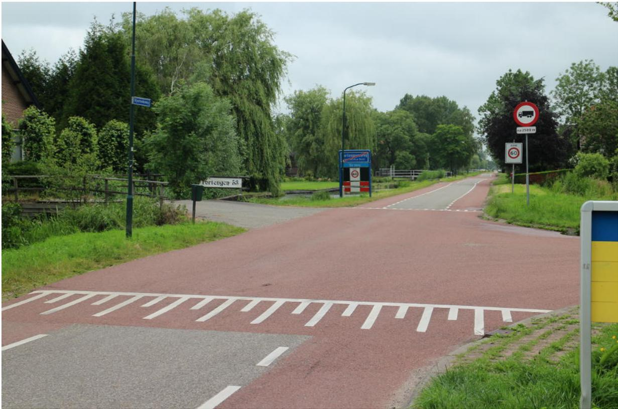
**Abbildung 8.4** Niederlande: Komplette Fahrbahnanhebung in einer Einmündung. Der angehobene Bereich wurde in rotem Belag ausgeführt. Weiße Markierungen zeigen den Beginn der Erhöhung an. (Bild: Dirk Schmidt 06-2015).
