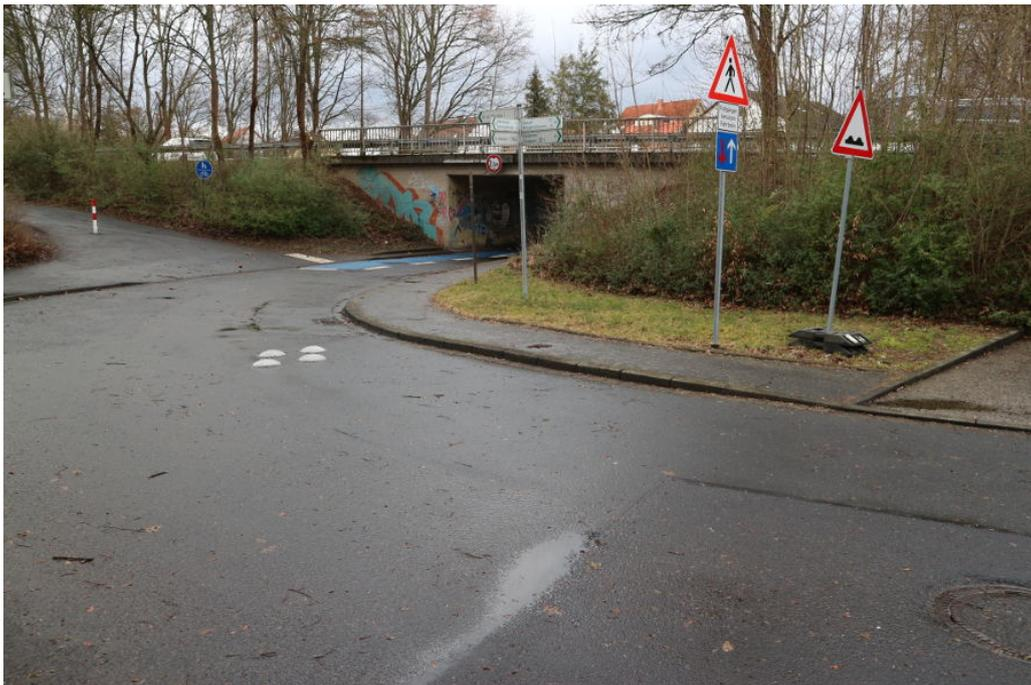
**Abbildung 8.2** Selbe Unterführung wie oben: Das Warnschild auf die Fahrbahnebenheiten wurde aufgestellt, nachdem ein Motorroller an den Kölner Tellern gestürzt war (Bild: Dirk Schmidt 11-2018).
