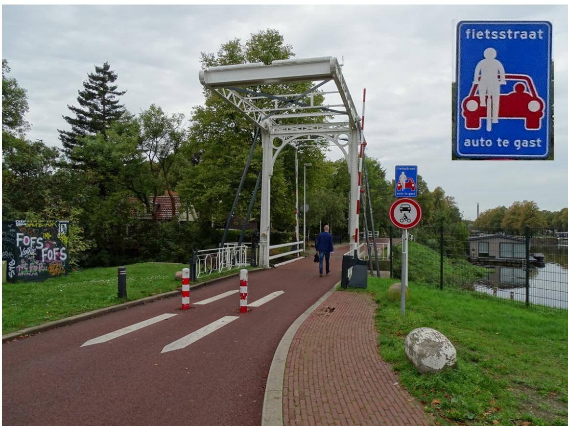
**Abbildung 10.17** Fahrradstraße Utrecht mit Schild „fietsstraat - auto te Gast“ (Fahrradstraße - Auto zu Gast) und modalem Filter (Pfostensperre). Bild: Swen Schneider 10-2019
