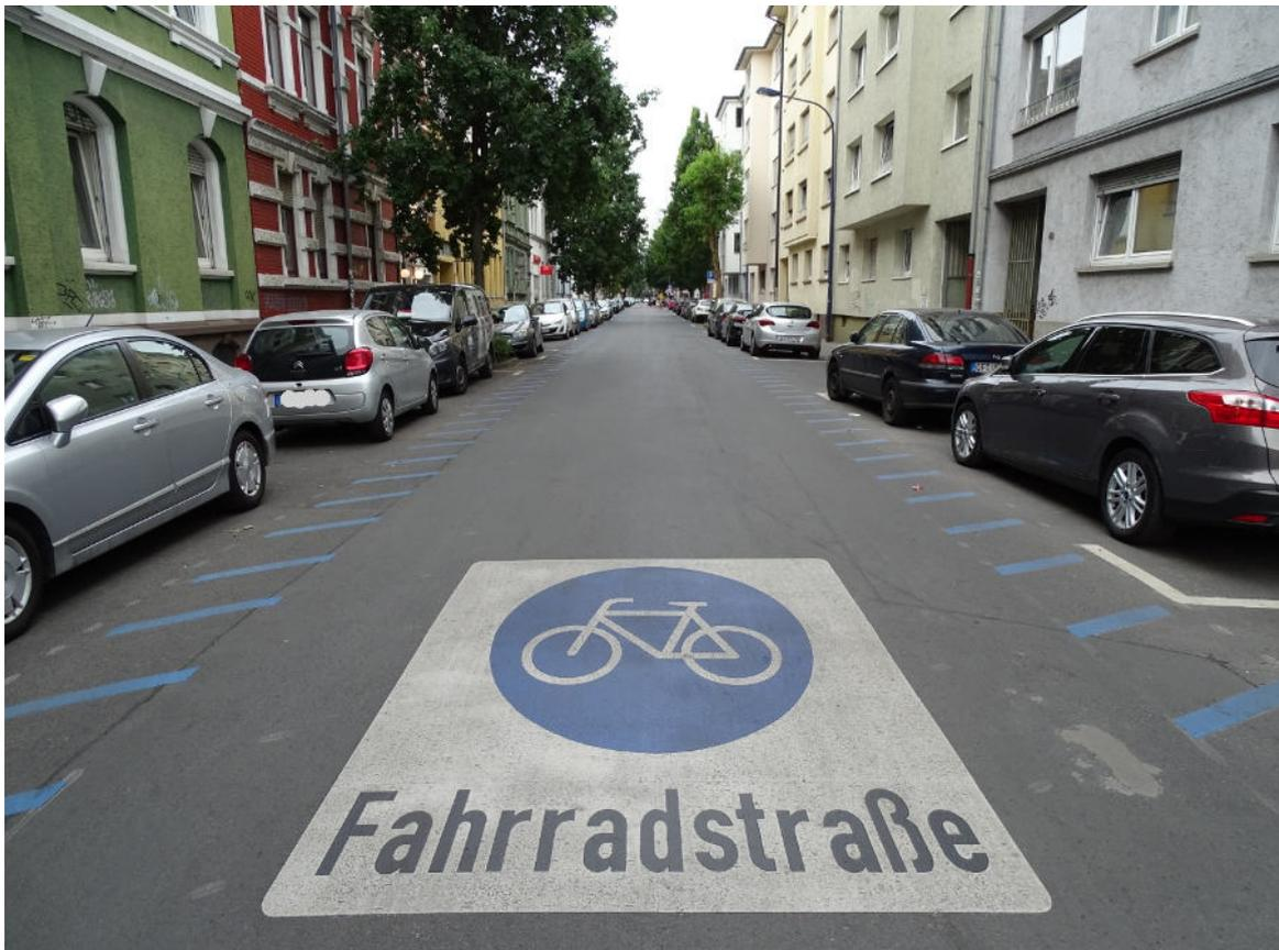
**Abbildung 14.1** Offenbach: Fahrradstraße „Tanusstraße“ mit blauer Schrägmarkierung: Der wichtige Sicherheitsabstand zu Längsparkern wurde so hervorgehoben. Bild: Swen Schneider 08-2020
