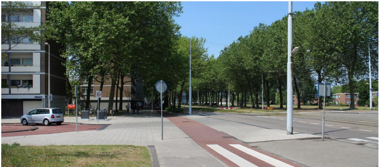
**Abbildung 11.5** Amsterdam: Baulicher Einrichtungsweg, der an einer Nebenstraße umfangreich baulich abgesichert ist. Der rostrote asphaltierte Einrichtungsweg verläuft parallel einer Hauptstraße und hat gegenüber den untergeordneten Einmündungen natürlich verkehrsrechtlich Vorrang. Dieser Vorrang wurde baulich umfangreich abgesichert. Solch eine Lösung erhöht natürlich gleichzeitig auch die Verkehrssicherheit des Fußverkehrs. Lage: Geo 52.35131 4.83232. Bild: Dirk Schmidt 06-2015
