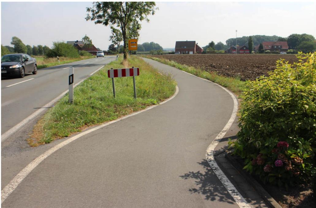
**Abbildung 3.10** Straßenbegleitende Radverkehrsanlage im Münsterland: Absicherung einer Kurve mit Fahrbahnbegrenzungslinien und einer Querbake. Bild: Dirk Schmidt 08-2016.
