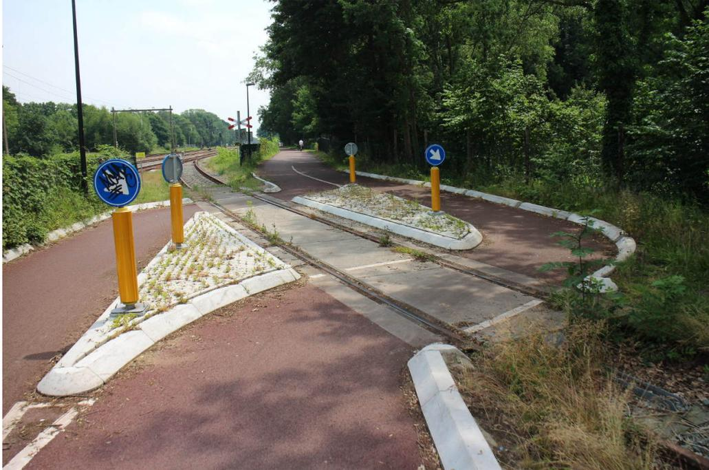
**Abbildung 4.9** Niederlande - Region Twente bei Geo 52.25353 6.81265: Vorbildlich wurde hier die Querung eines Werksanschlusses mit einer baulichen Wegverschwenkung abgesichert. Der Radverkehr quert in noch sicherem Winkel die Schienen. Gefährlichen, zu spitzen Fahrwinkeln mit Sturzgefahr wird so wirksam vorgebeugt! Bild: Dirk Schmidt 06-2015
