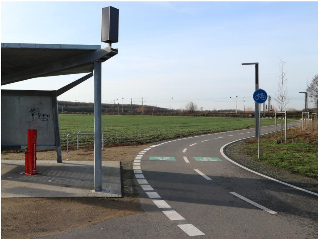
**Abbildung 3.8** Bedarfsgerechte Kurvenradien am fertigen Teilstück der Radschnellverbindung Darmstadt - Frankfurt bei Egelsbach (Bild: Dirk Schmidt 12-2019)
