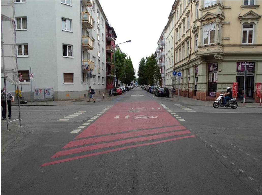
**Abbildung 10.10** Offenbach Fahrradstraße Taunusstraße: Der Vorrang wurde u. a. mit Hilfe von großen, roten Sicherheitsmarkierungen hervorgehoben. Bild: Swen Schneider 08-2020
