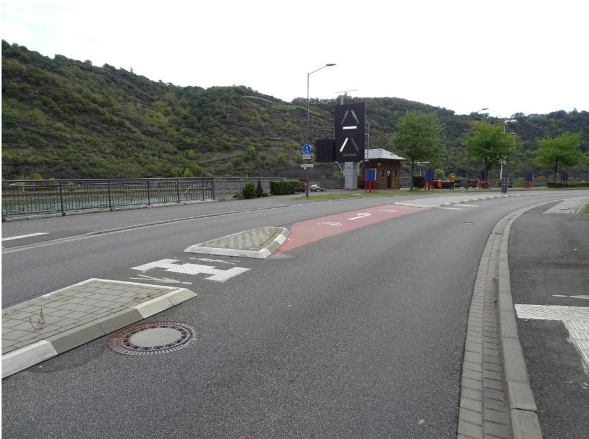
**Abbildung 11.7** Blick auf die Längsinsel. Diese wird genutzt, wenn man von der Fahrbahn (innerörtlich ohne Radwege) auf den außerorts (auf der Rheinseite) liegenden Zweirichtungsradweg gelangen möchte.
