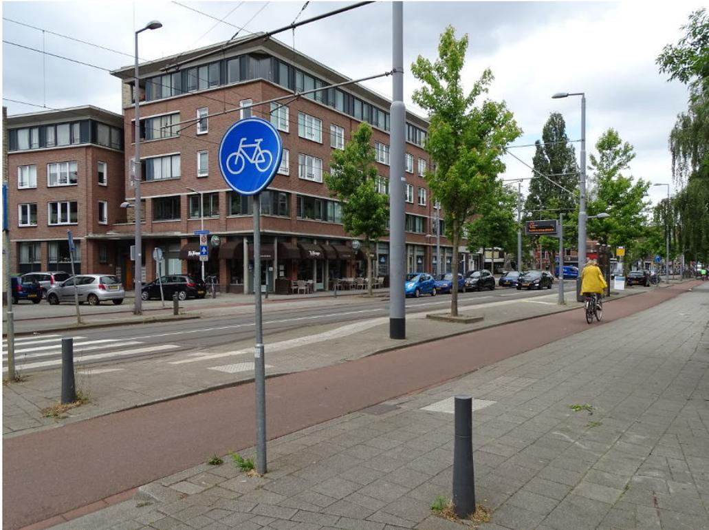
**Abbildung 11.10** klassisch Niederländisch: hochwertige, bauliche Radwege in Rotterdam an einem Tramhalt (Bild: Swen Schneider 06-2020)
