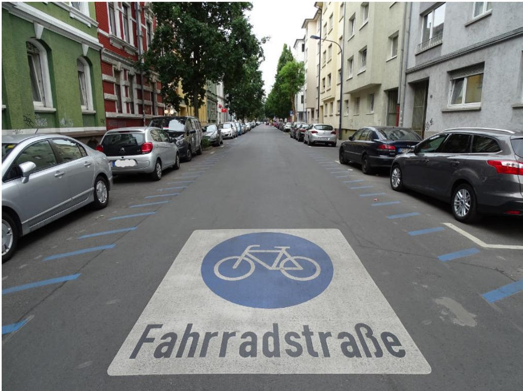
**Abbildung 10.1** Offenbach Fahrradstraße Taunusstraße mit blauer Schrägmarkierung: Auch der wichtige Sicherheitsabstand zu Längsparkern wurde hervorgehoben. Bild: Swen Schneider 08-2020
