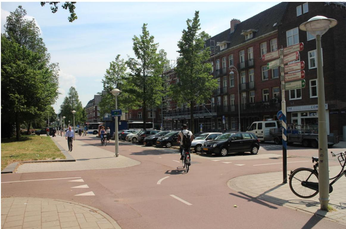
**Abbildung 19.8** Blick auf den separaten Radweg an der Theophile de Bockstraat: Radwegweisung steht rechts an der Laterne. Eine separate Beleuchtung besitzt die Route ebenfalls. Bild: Dirk Schmidt 06-2015.
