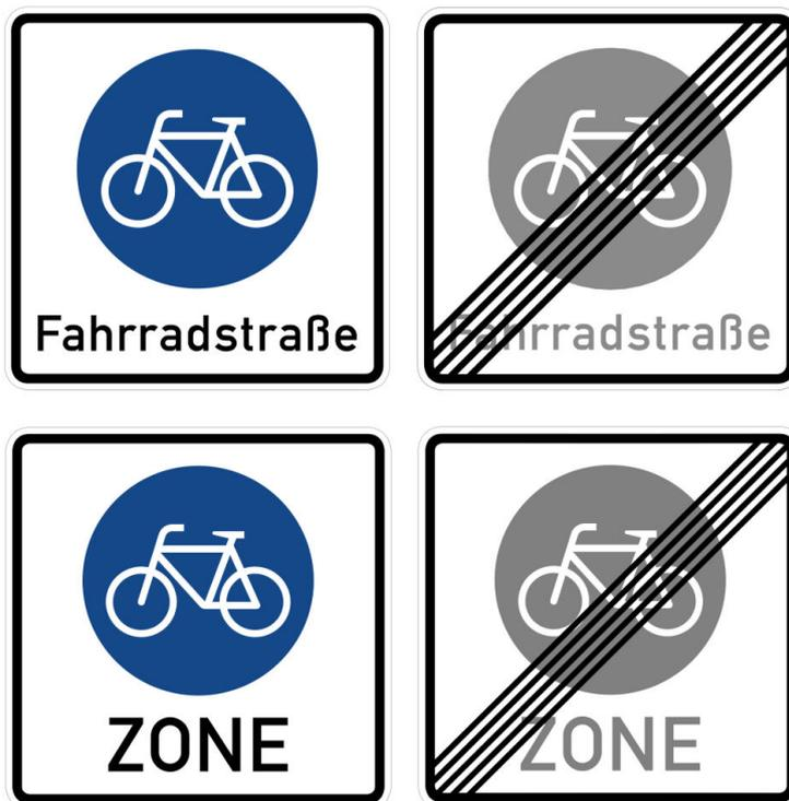
**Abbildung 10.20** Vergleich Zeichen Fahrradstraße und Fahrradzone. oben links: Zeichen 244.1 „Beginn der Fahrradstraße“, oben rechts: Zeichen 244.2 „Ende der Fahrradstraße“, unten links: Zeichen 244.3 „Beginn einer Fahrradzone“, unten rechts: Zeichen 244.4 „Ende einer Fahrradzone“
