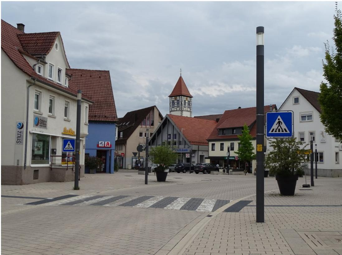
**Abbildung 21.2** Zebrastreifen: die Vorfahrtsstrasse besitzt trotz Tempo 30 auch in der verkehrsberuhigten Gestaltung Querungshilfen für den Fußverkehr (mit taktilem Leitsystem für Blinde). Aufgrund der hohen Verkehrsbelastung ist dies sinnvoll. Bild: Swen Schneider 09-2019
