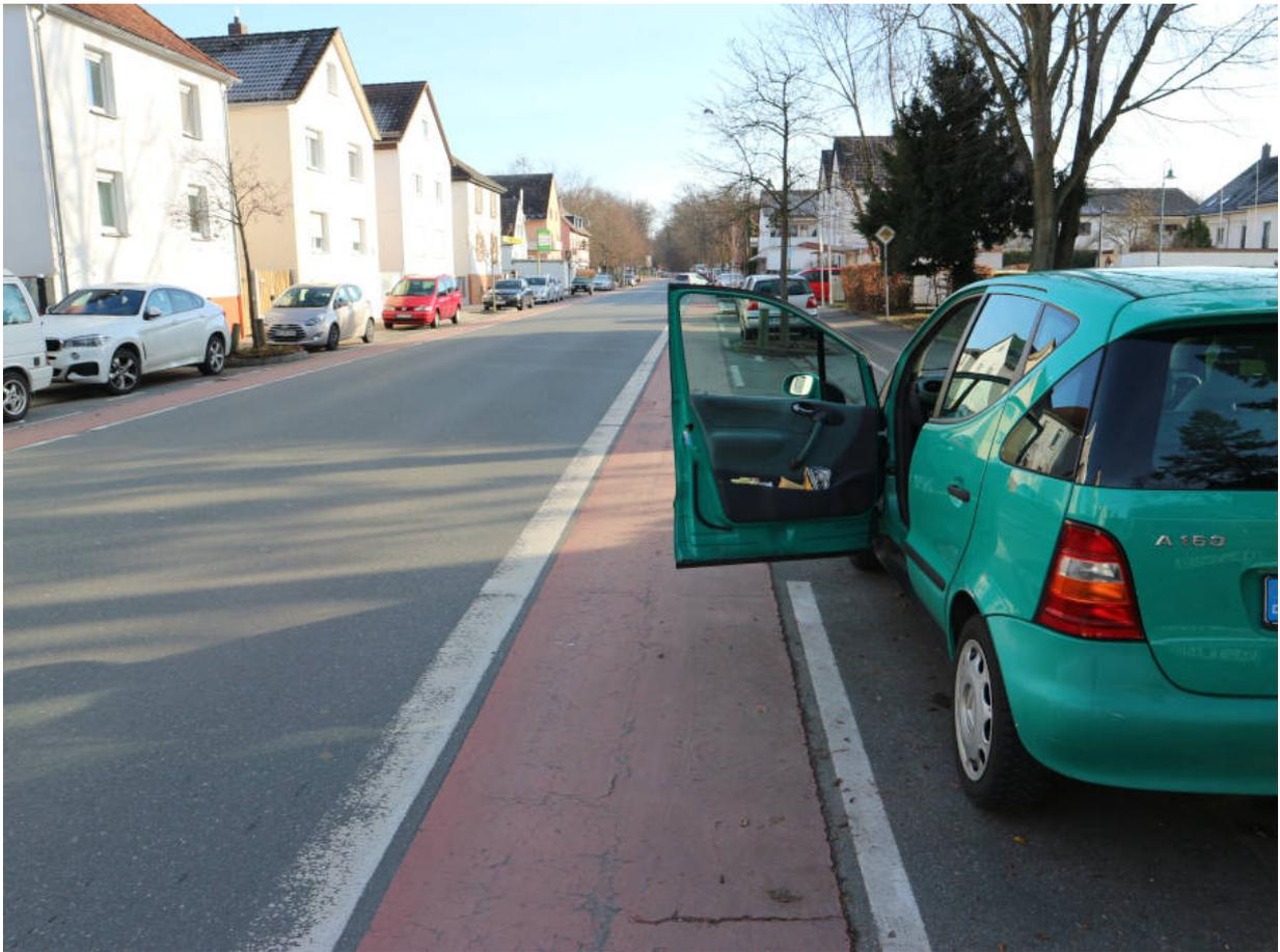
**Abbildung 14.2** Die Fahrspur dieses Radfahrstreifens liegt im Prinzip komplett in der Autotürenzone. Ob die Radfahrstreifen der ERA 2010 entsprechen wurde vor Ort nicht nachgemessen (Bild: Swen Schneider in 2019).
