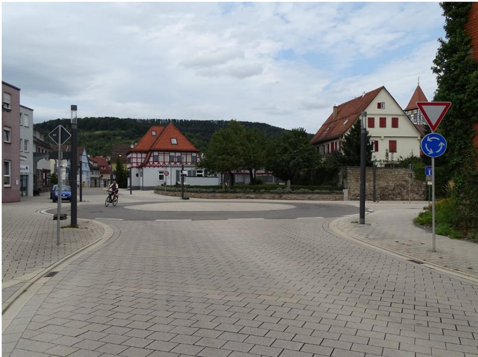
**Abbildung 21.6** Tempo 30 in Rudersberg bei verkehrsberuhigter Gestaltung. Im Streckenabschnitt gibt es auch einen Minikreiverkehr. Bild: Swen Schneider 09-2019
