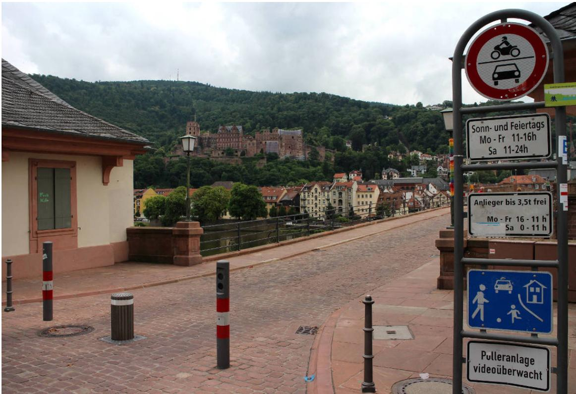
**Abbildung 20.6** Heidelberg / Alte Brücke: Der verkehrsberuhigte Bereich ist tagsüber zu den Hauptbesuchszeiten nur für den nichtmotorisierten Verkehr freigegeben. In den Nebenzeit dürfen auch motorisierte Anlieger bis 3,5 Tonnen die Alte Brücke befahren. Der zeitliche Zugang wird mit einem versenkbarem Poller geregelt. (Geo: 49.41516 8.70938 Bild: Dirk Schmidt 07-2014)
