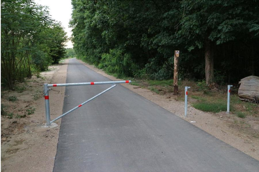
**Abbildung 7.10** Südhessisches Ried: Graue Halbschranke auf dem neu ausgebauten hessischen Radfernweg R9 zwischen Lorsch und Bürstadt: Diese Halbschranke ist zwar gut durchfahrbar, aber nur mit wenigen Reflektoren ausgestattet. **Da die Schranke außerorts in einer unbeleuchteten Örtlichkeit steht, sollte bei den Reflektoren unbedingt noch nachgerüstet werden.** Bodenmarkierungen wären zusätzlich wichtig. Bild: Dirk Schmidt Sommer 2017
