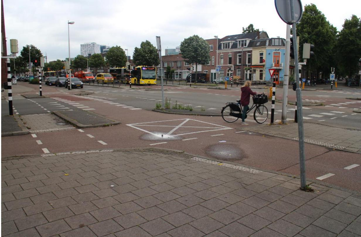
**Abbildung 19.13** Utrecht: „Schutzkreuzung“ mit baulich ausgebildeten Linksabbiegerbereichen (Standardgeometrie in den Niederlanden, Bild: Dirk Schmidt 06-2015)
