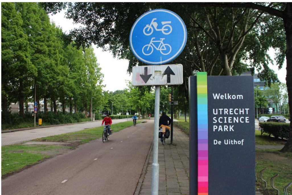
**Abbildung 16.2** Kombiniertes Bromfiets- und Fietspad in Utrecht. Hier gibt es rechts einen separaten, gepflasterten Gehbereich. Bild: Dirk Schmidt 06-2015).
