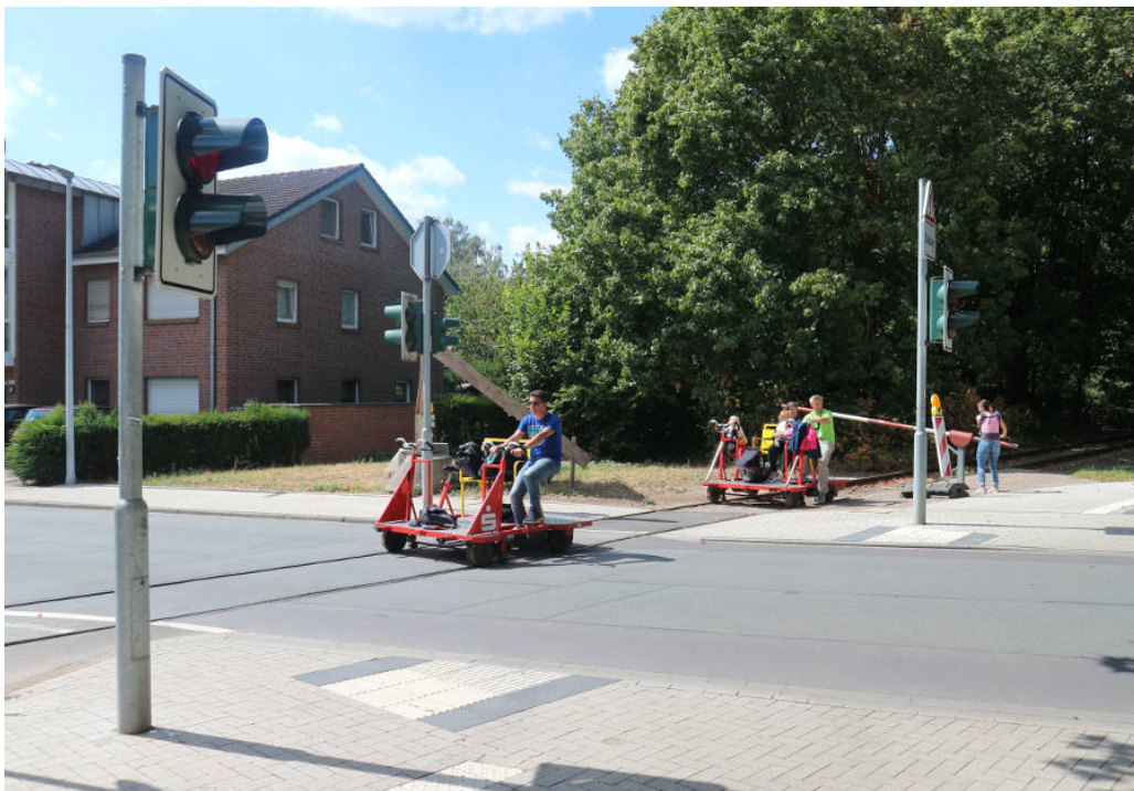
Abbildung 10.14 Bildunterschrift: Draisinen am Übergang Flutstraße in Kleve. Die Übergänge der Draisinenstrecke wurden mit Anforderungsampeln gesichert. Die Draisine hält vor der Schranke. Jemand steigt ab und drückt für grün an der Bedarfsampel. Ist diese grün, öffnet man die Handschranken und quert die Straße.
