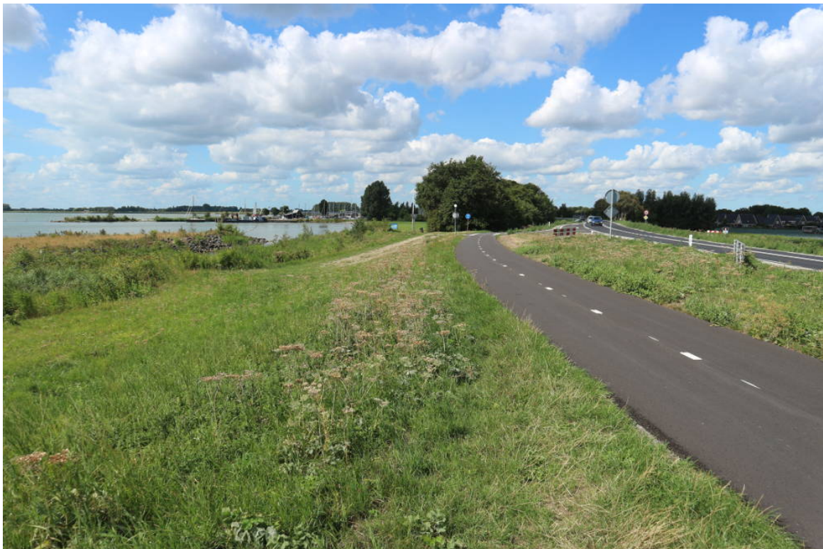
Abbildung 8.1 Bildunterschrift: Deichblick südlich Enkhuizen. Dieser straßenbegleitende Zweirichtungsradweg hat übrigens eine Breite von "9,5 Schuhen". Bei Schuhlänge von 29 cm ergibt das eine Breite von 2,75 m (rund 2,8 m).
